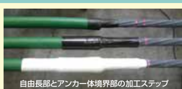
自由長部とアンカー体境界部の加工ステップ
