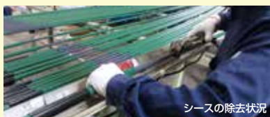
シースの除去状況
